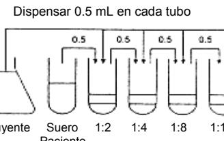
Después, cada tubo es probado con látex siguiendo el procedimiento debajo la sección A. Método cualitativo.
